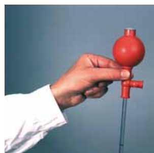
2. Aspirar presionando el punto B (↑)
