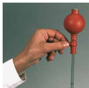
3. Expulsar el líquido presionando el punto A (↓)
